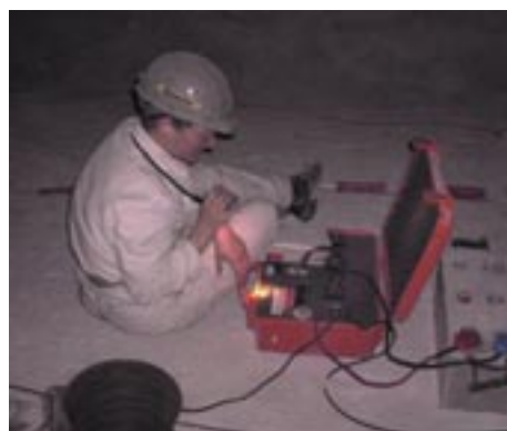
Geoelektrische Untertage-Messungen in einem Salzbergwerk
