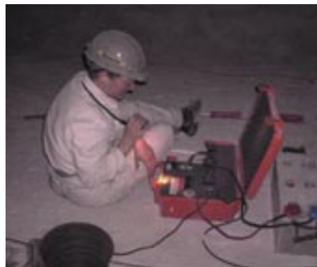
Geoelektrische Untertage-Messungen in einem Salzbergwerk
