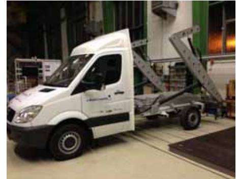
Kleincontainertransporter mit Containerhubeinrichtung für die innerstädtische Logistik
