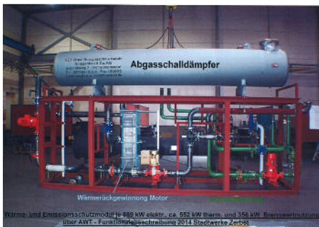
Neue Ergänzungsmodule für eine BHKW-Anlage zur Verbesserung der Energieeffizienz bzw. des Gesamtwirkungsgrades
