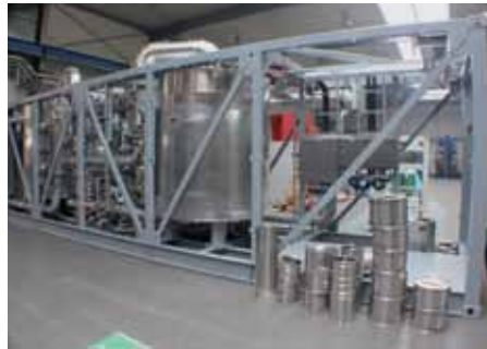
Modular aufgebaute Kraft-Wärme-Kopplungsanlage
