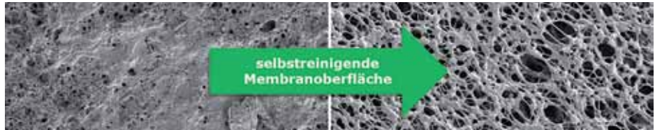
Rasterelektronenmikroskopieaufnahmen einer benutzten Membranoberfläche vor (links) und nach (rechts) einer Oberflächenmodifizierung
